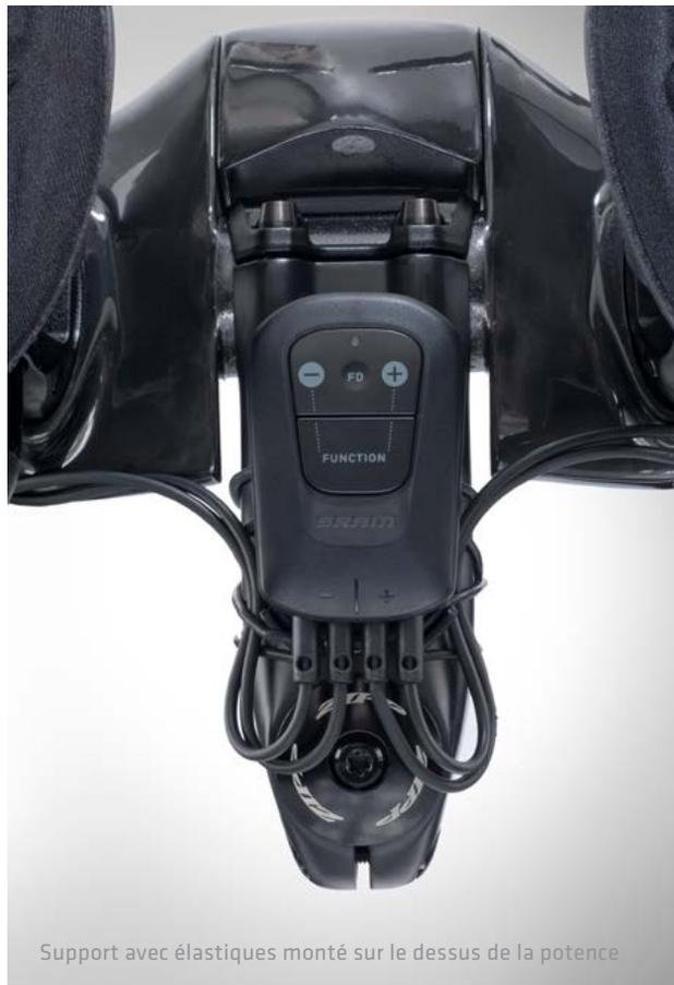
Support avec élastiques monté sur le dessus de la potence
