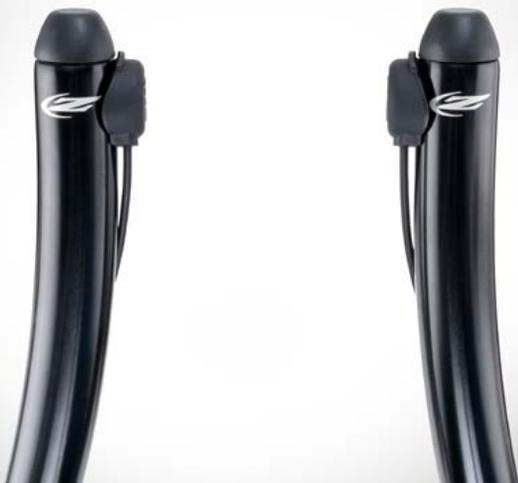
Blips positionnés sous les extensions aéro sans guidoline.
