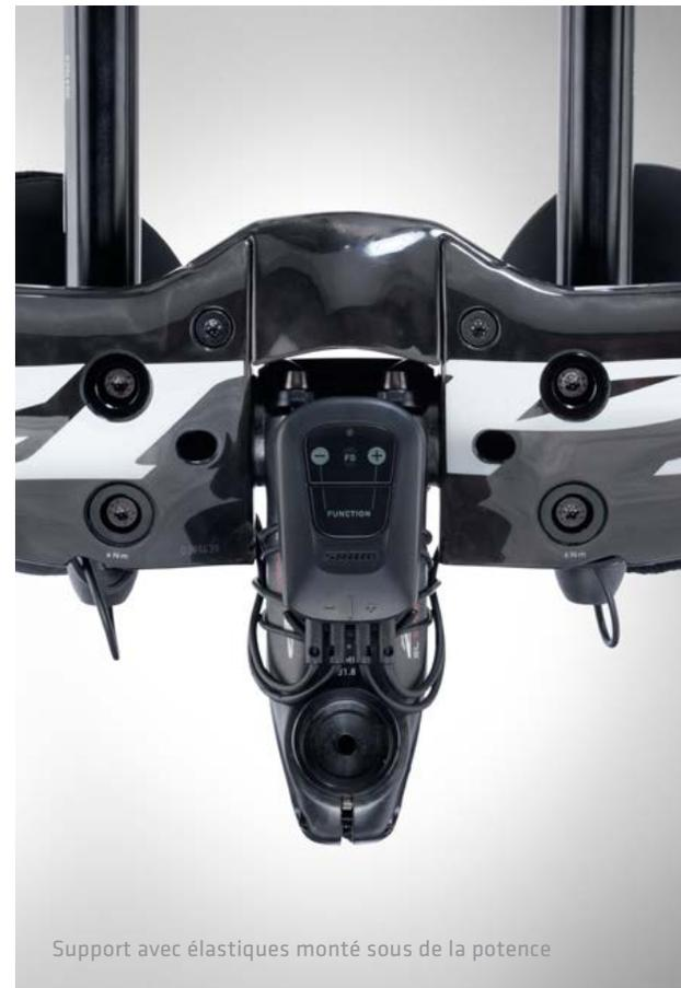
Support avec élastiques monté sous de la potence
